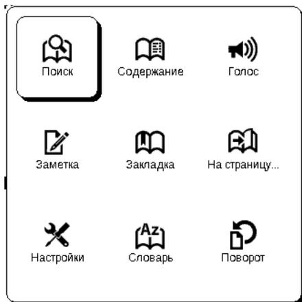
Меню быстрого доступа вызывается нажатием и удерживанием клавиши «ОК» в режиме чтения книги. Содержимое меню быстрого доступа зависит от программы, в которой открывается книга (от ридера). Меню содержит следующие пункты:
